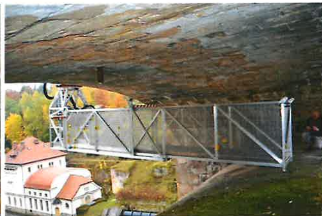
-Přístup pod most prohlížečkou MOOG
